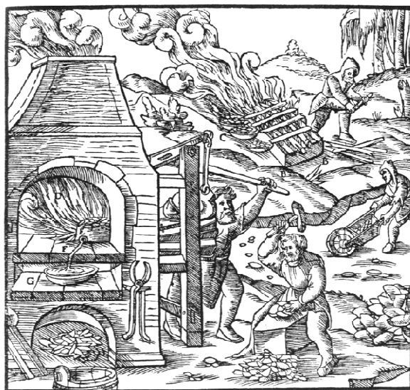
Praca przy piecu fryszerskim (w tle wypalanie węgla drzewnego). Rycina z książki „De Re Metallica”
